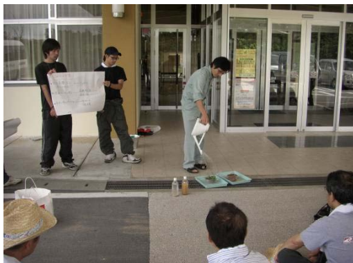
名桜大・田代先生が赤土流出を実験で示してくれる。植栽されたポットからは土は流れない。
